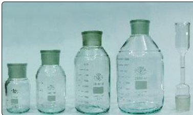
Şişe Tip Özgül Ağırlık Piknometresi ( Hunili )
