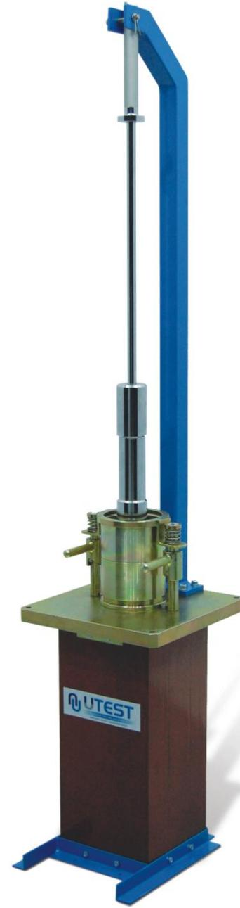
Los ensamblajes para Compactación Manual de Marshall viene con;
