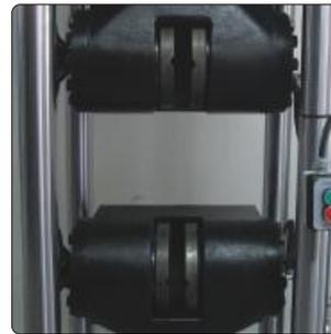
Apertura (luz) para Ensayos de Tensión
