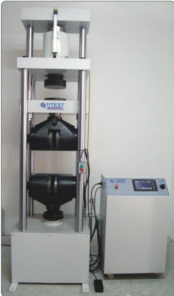
La UTM-4000 Máquina Hidráulica Universal está diseñada para hacer pruebas de materiales ferrosos para valores estructurales como fuerza de rendimiento y fuerza de tensión. Aparte de pruebas de tensión, las Máquinas Hidráulicas Universales también pueden estar usadas para pruebas de compresión hasta la capacidad de la máquina.
