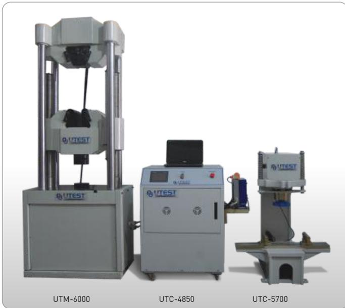
UTC-4850 con UTM-6001 Marco de Carga para Pruebas Universales de 600 kN y UTC-5700 Marco de Carga para Flexión de 300 kN
