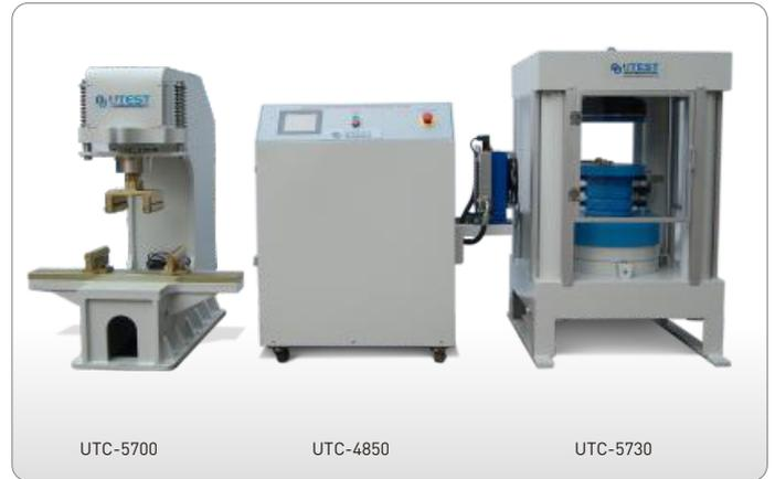
UTC-4850 con UTC-5730 Marco de Carga de Cuatro Columnas de 3000 kN y UTC-5700 Marco de Carga para Flexion de 300 kN, Tipo C
