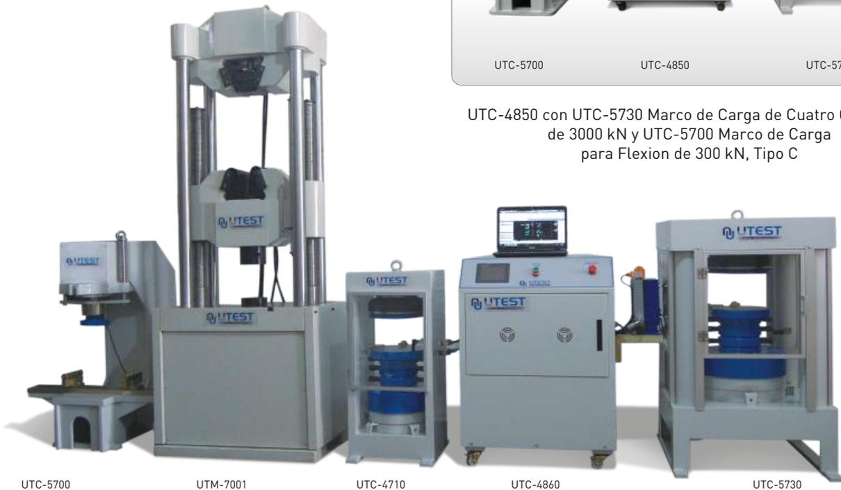
UTC-4860 con UTC-5730 Marco de Carga de Cuatro Columnas de 3000 kN, UTC-4710 Marco de Carga de 1,500 kN, UTC-5700 Marco de Carga para Flexión de 300 kN y UTM-7001 Marco de Carga para Pruebas Universales de 1,000 kN
