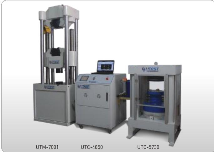
UTC-4850 con UTC-5730 Marco de Carga de Cuatro Columnas de 3000 kN y UTM-7001 Marco de Carga para Pruebas Universales de 1,000 kN
