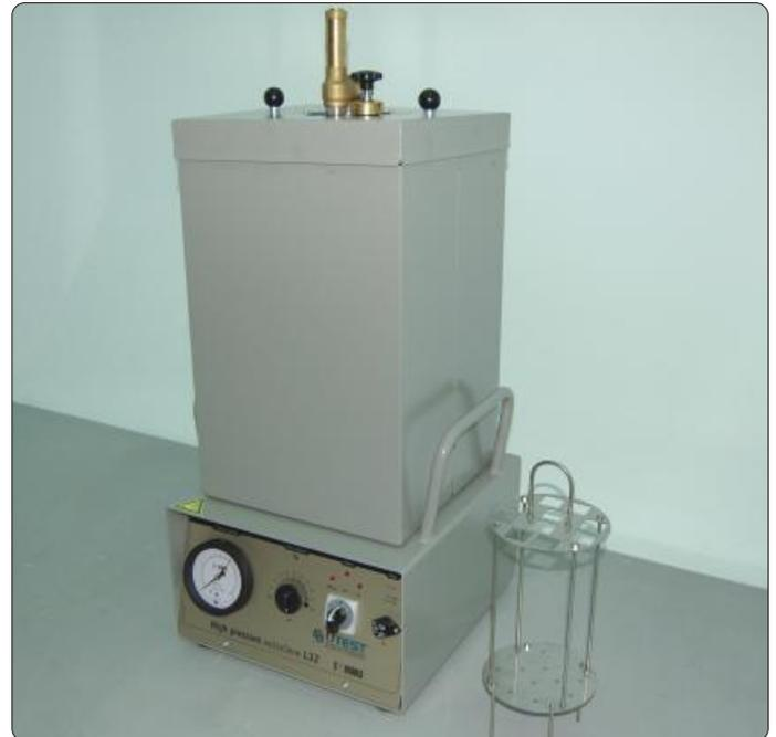
El Autoclave de Alta Presión para Cemento viene con;
