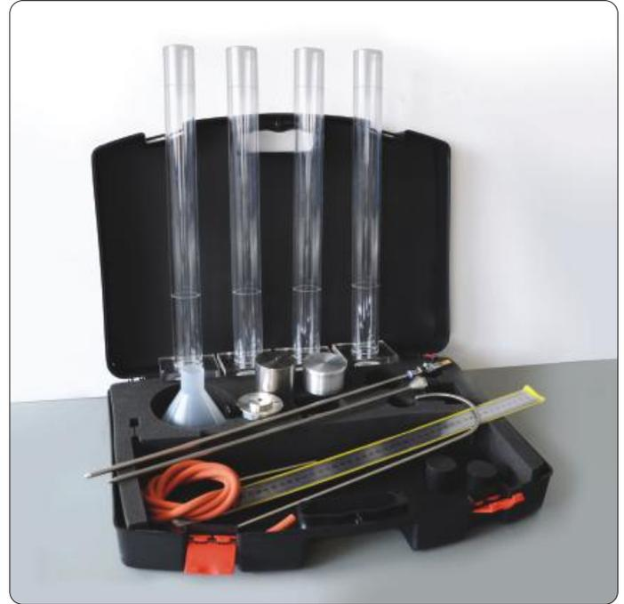
El conjunto de equipo para ensayos de equivalente de arena viene con:
